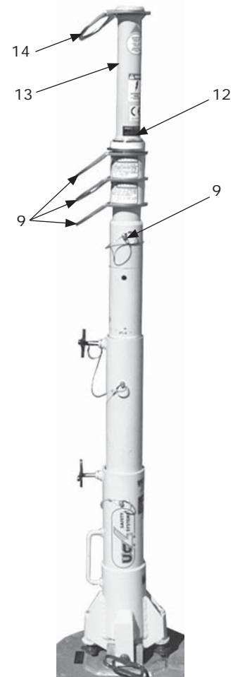
Figura 9 – Extensão do poste de amarração
